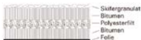
Figur 1 Opbygning af PTM BituFlex
