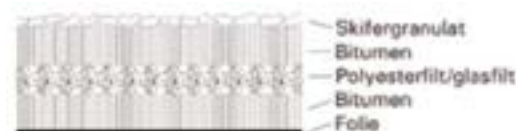
Figur 2 Opbygning af PTM BituFlex Kombi
