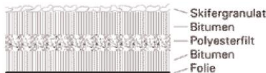
Figur 1 Opbygning af PTM BituFlex
