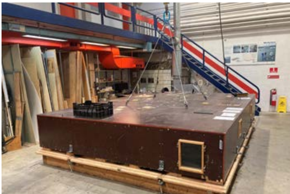
Foto 1.8.1: PTM's sugkasse, som anvendes til prøvning i henhold til EN 16002.
