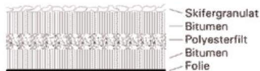
Figur 1 Opbygning af PTM BituFlex
